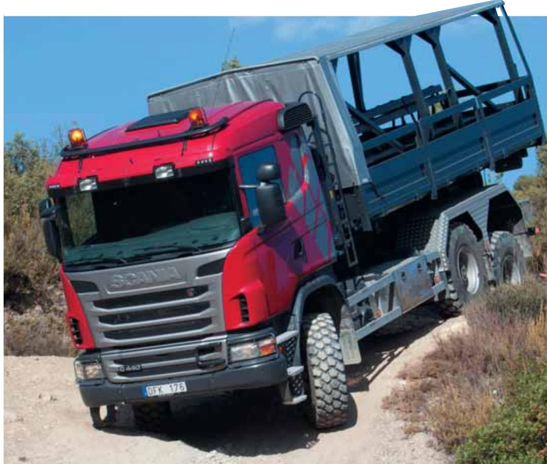
детального тест-драйва я выбрал две, которые, как мне показалось, имеют шанс быть наиболее востребованными на российском рынке. Речь пойдет о Scania G 440 CB 6x6 HHZ. Этот трехосный полноприводный мультифункциональный грузовик покорил меня своей универсальностью, которая достигается модульной быстросъемной конструкцией надстройки, но не менее интересна и конструкция его шасси.
