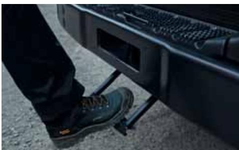
Откидная ступенька и просторная площадка над бампером создают все условия для ухода за ветровым стеклом. Палец буксирующего устройства выдерживает нагрузку до 35 т, это на 10 т больше стандартной, и позволяет при необходимости буксировать полностью гружёный автомобиль
