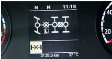
Процесс блокировки дифференциала: пиктограмма текущего состояния оси показывает, что все устройства включены, а также выбран пониженный режим работы трансмиссии
