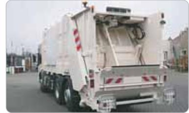
Специальный бункер и загрузочное устройство для раздельного (селективного) сбора отходов.
