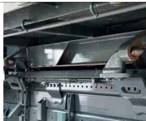
Механизм, обеспечивающий быструю смену стандартизированной надстройки, в России называют multilift...
