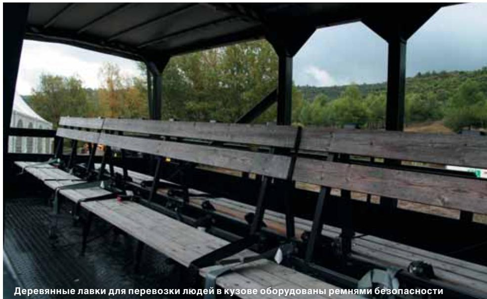
Деревянные лавки для перевозки людей в кузове оборудованы ремнями безопасности
